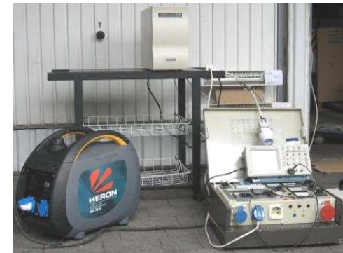
HERON DGI 20 Q áramfejlesztő EFFEKTA MH 2000 line interaktív szünetmentes tápegység
