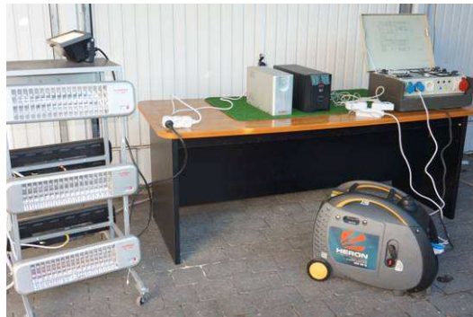
HERON DGI 30 Q áramfejlesztő APC SPS MID 2000 RTI és SV 620 szünetmentes tápegységgel
