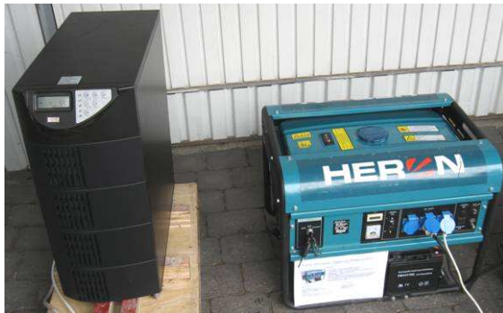
HERON EGM 55 AVR-1E áramfejlesztő EFFEKTA MH 6000 on-line szünetmentes tápegységgel
